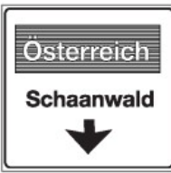
4.42 Einspurtafel über Fahrstreifen auf Nebenstrassen (Art. 52)
