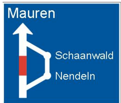
4.53 Vorwegweiser für Umleitungen (Art. 54)
