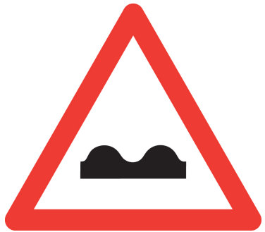
1.06 Unebene Fahrbahn (Art. 6)
